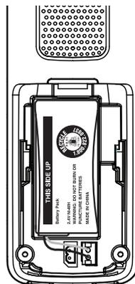
3. Glissez le couvercle du compartiment de la pile vers le centre du combiné, jusqu'à ce qu'il se verrouille en place.
